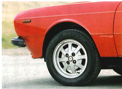
ベータが登場して以来、最近のテーマなどまで多く使われてきている放射状スポーク・デザインの軽合金ホイール（撮影車に装着されていたのはクロモドラ製）。この造形は、オリジナルのデザイナー、マリオ・ボラーノが戦前のブガッティ・タイプ35に啓発されたもの。
